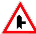
A-030 Útkereszteződés alárendelt úttal (3)
