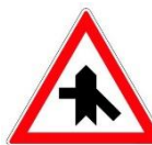
A-036 Útkereszteződés alárendelt úttal (9)
