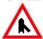
A-032 Útkereszteződés alárendelt úttal (5)
