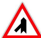
A-031 Útkereszteződés alárendelt úttal (4)
